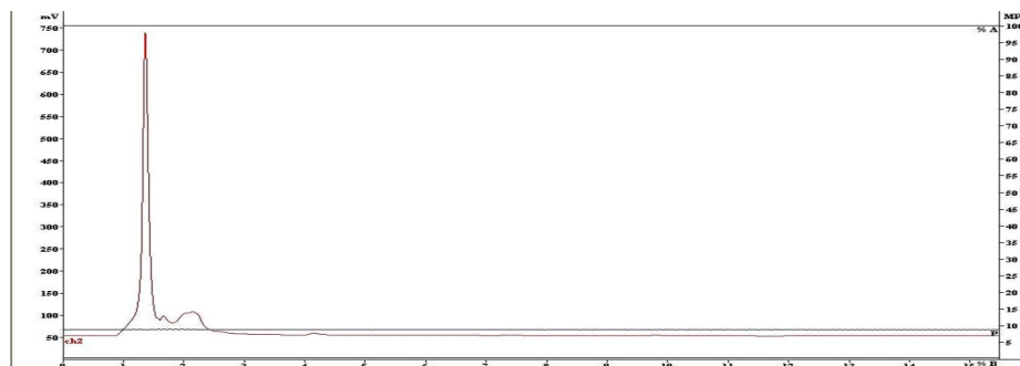
Рис. 6. Хроматограммы водки «Выпьем за»: а) до очистки; б) после очистки пропусканием через фильтр с углеродными нанотрубками
